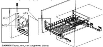
с прикрученными держателями К и корзину L, нужно убедиться, что винт F не вставлен в держатель К. Винт F нужно вставить после установки фасада на корзину L и затянуть после завершения регулировки.
